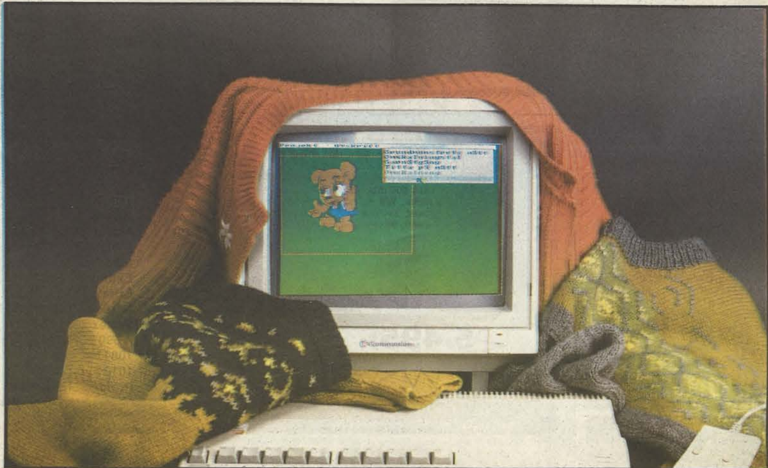
På skärmen ser du den bild som ska bli stickmönster. Björnen har ännu rätt proportioner. Jämför med printerutskriften nedan, där bilden deformerats för att passa maskornas proportioner.
